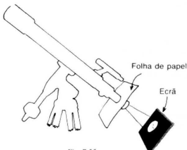
Figura 6.1 – esquema da montagem para o método da projecção (Ferreira, 1999)
