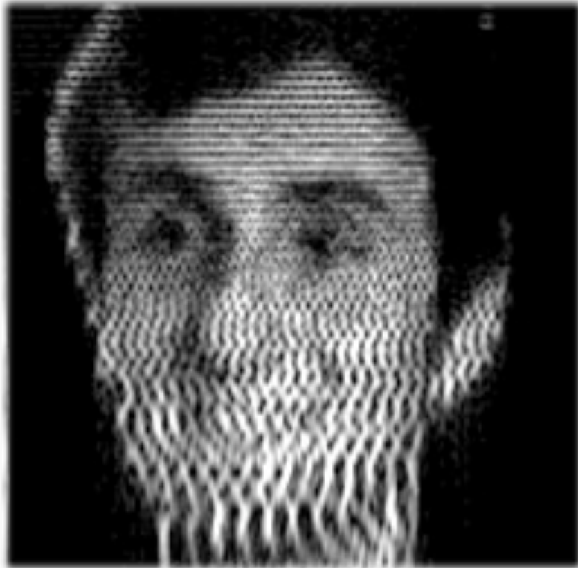
Fig. 41 Reconstrucción de una persona hecha por computadora a partir de un segundo de sonido, según la interpretación del sistema The vOICe
