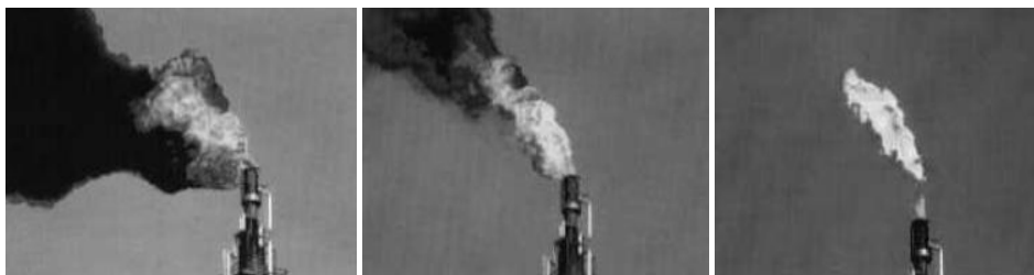
Figura 6 -Efeito da injeção de vapor na combustão - a) sem injeção de vapor; b) início da injeção de vapor; c) injeção de vapor contínua (Charles e Baukal, 2001).
