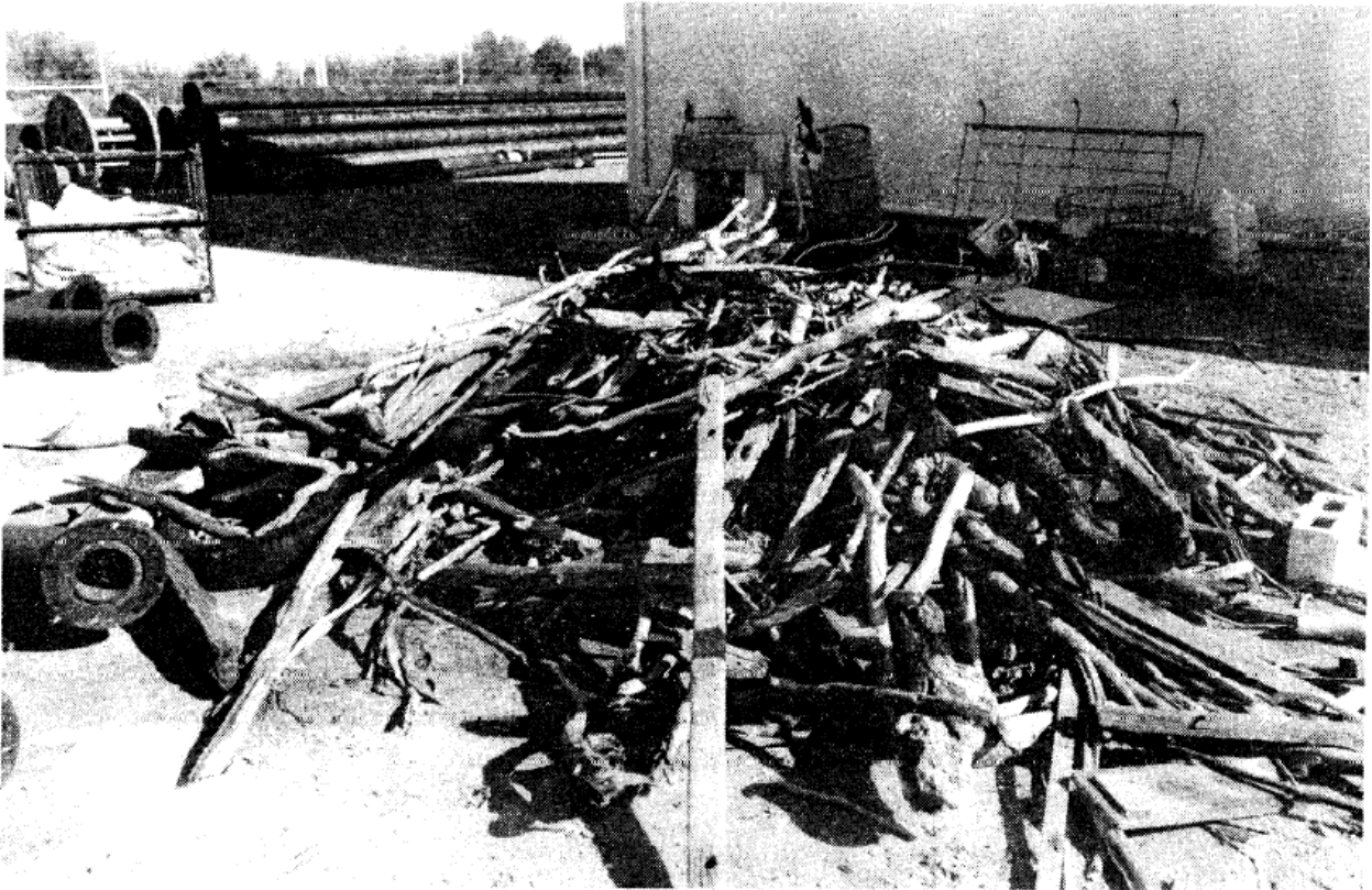
Figura A1.14 – Detritos acumulados na cratera de aspiração de uma bomba de jacto (Gregory L. Williams, James E. Clausner – 1990)
