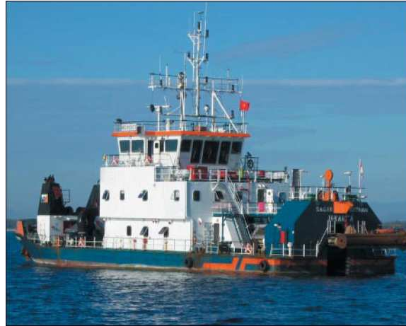
Figura 3.18 – Draga de injeção de água ou 'water injection dredge' ( www.vanoord.com )
