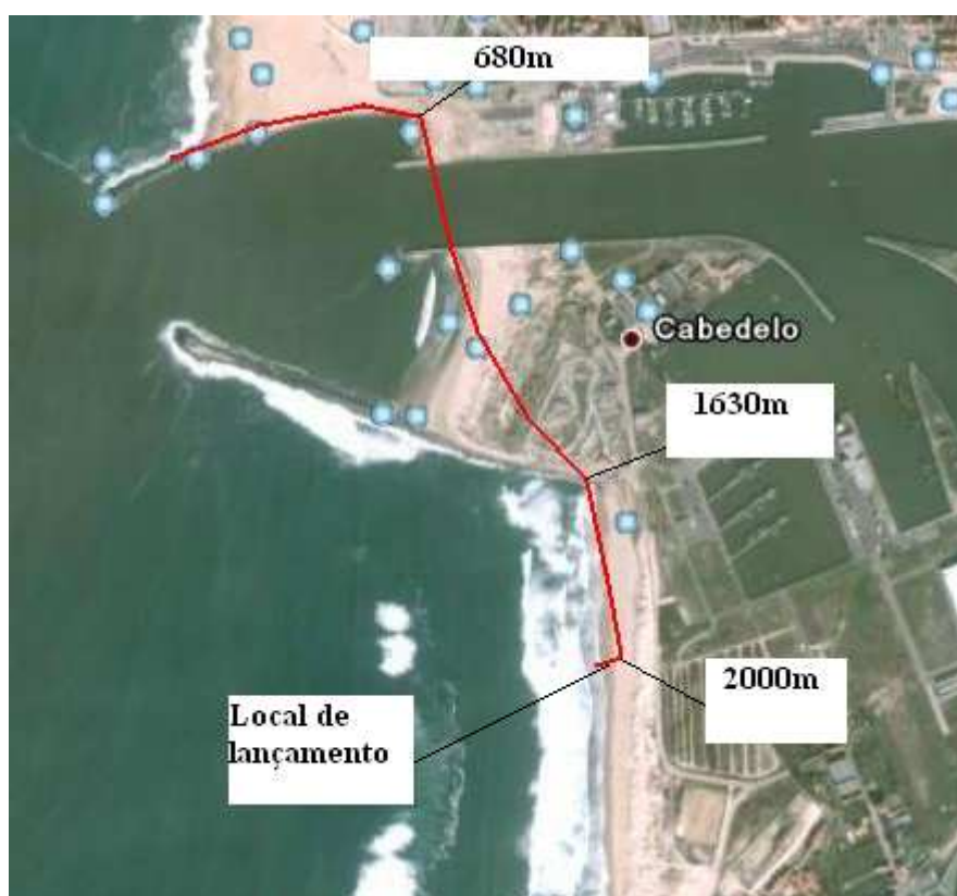
Figura 5.10 – Possível configuração do traçado da conduta no porto da Figueira da Foz
