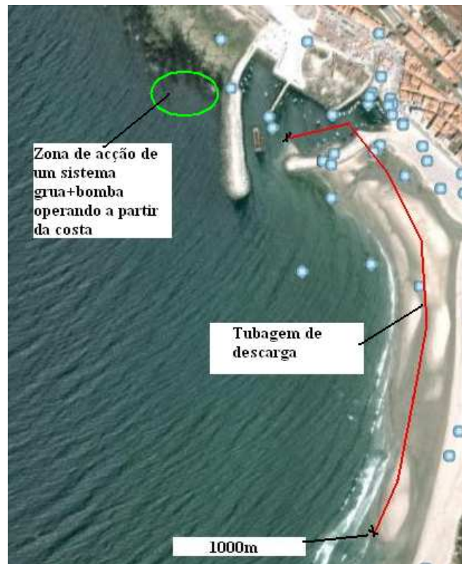
Figura 5.8 – Possível traçado da conduta (google earth)
