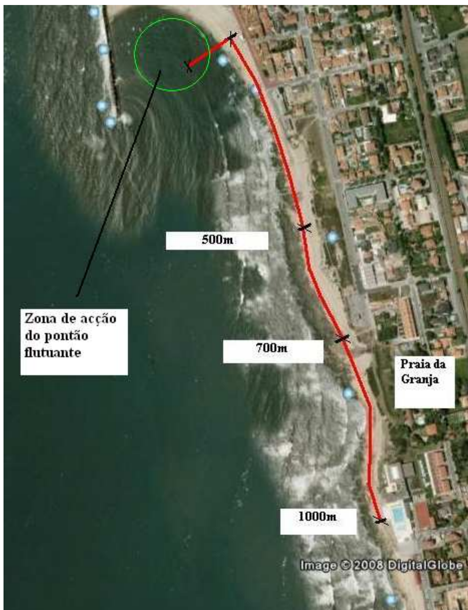
Figura 5.3 – Configuração da conduta (google earth)
