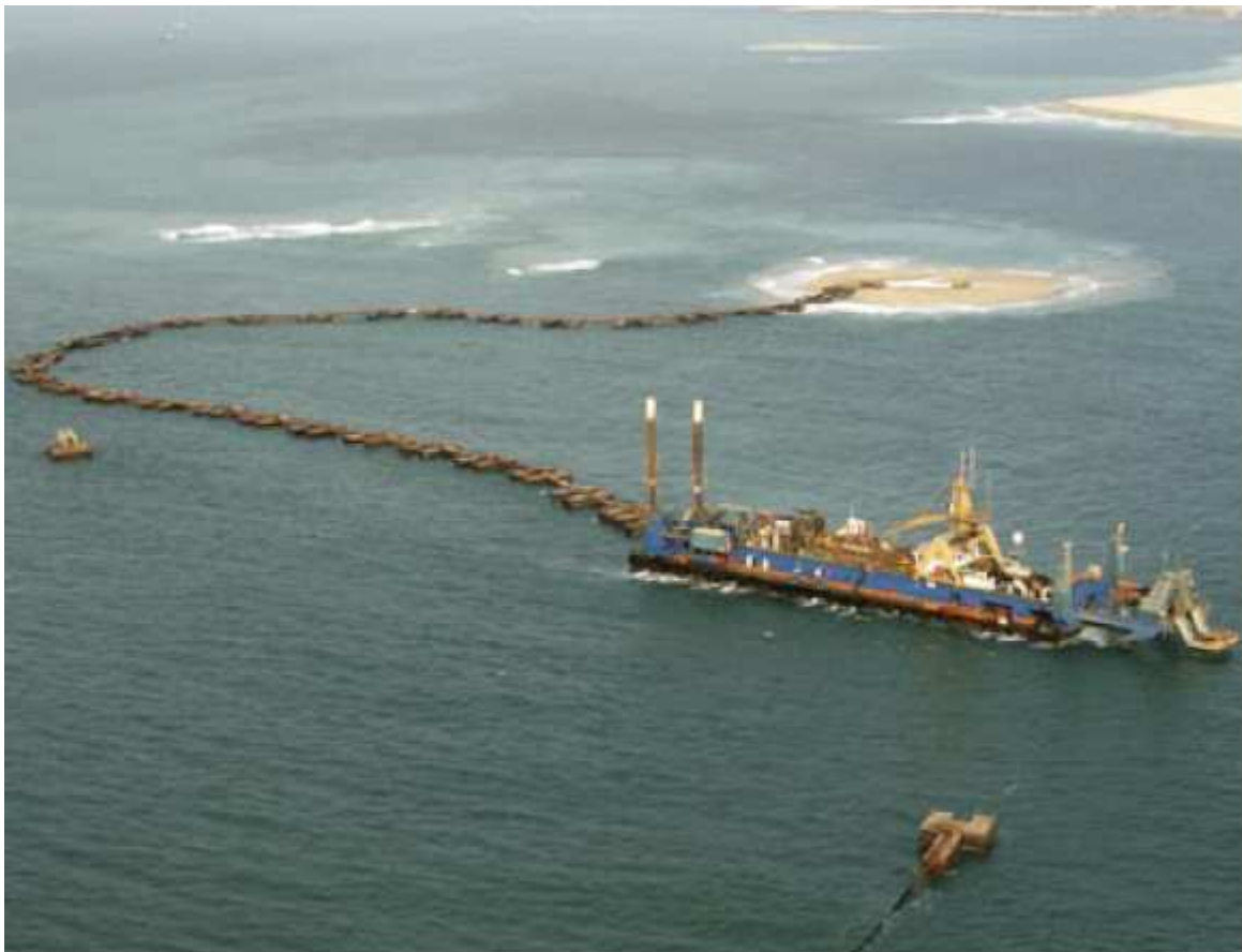
Figura 3.17 – Draga de sucção estacionária em operação (www.vanoord.com)
