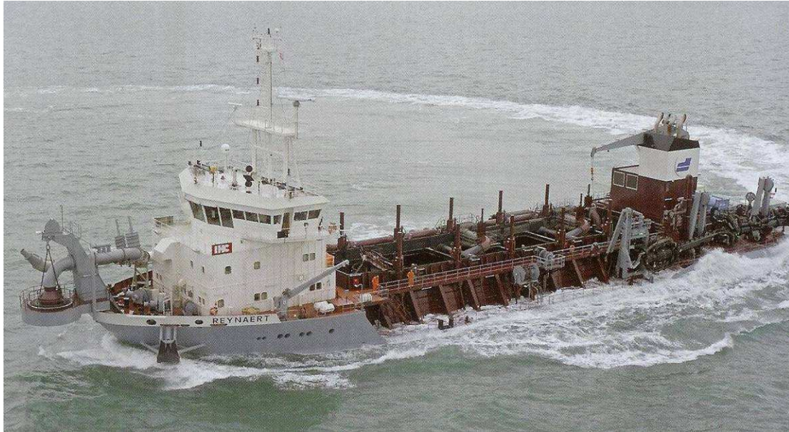
Figura 3.4 – Barcaça de grande volume de porão (Ports and Dredging - 2007)
