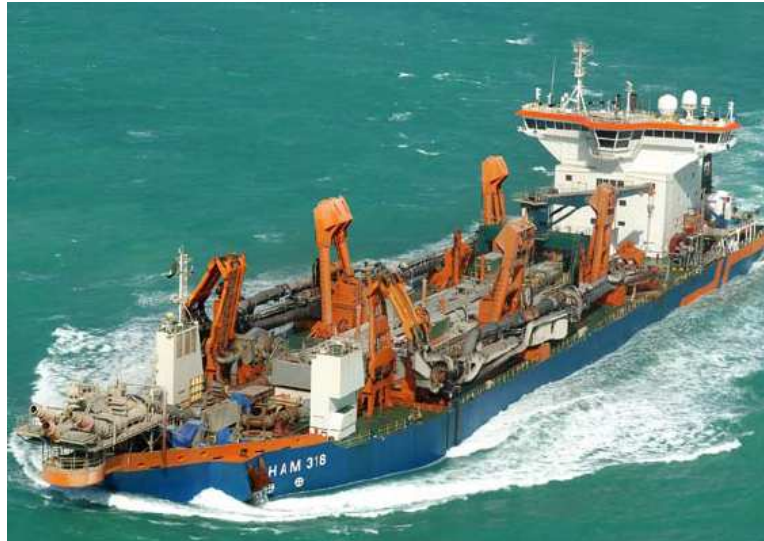
Figura 3.14 – Draga de sucção não estacionária (www.vanoord.com)
